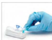
4. Položte SNAP-tester na vodorovnú podložku. Opatrne nalejte celý obsah skúmavky so vzorkou do testovacej jamky tak, aby nedošlo k poliatu okolia jamky.
