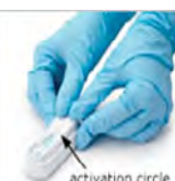
5. Hneď ako sa PRVÝ KRÁT objaví v aktivačnom oku zafarbenie, zatlačte pevne aktivátor tak, aby správne licoval s okrajom SNAP-testera. Budete počuť zreteľné „snap“.
