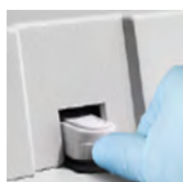
6. Vložte SNAP-tester do analyzátoru.
